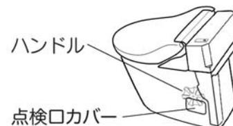
3. 点検口内の停電用ハンドルを回して排出します。
