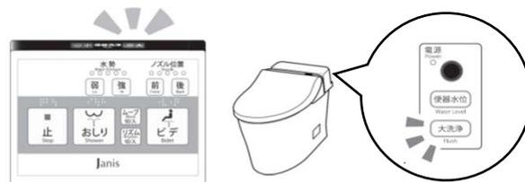
●断水復旧時、配管内に空気が残っていた場合、最初の洗浄時に洗浄ノズルから勢いよく水が飛び出す可能性がありますので、ポリ袋などで洗浄ノズルの周囲を養生してください。
